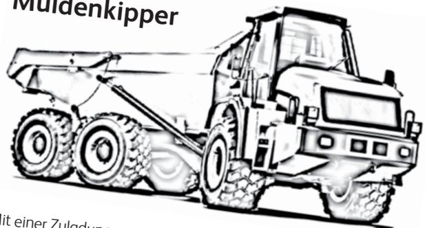
Mit einer Zuladung von 15 bis 365 Tonnen sind Muldenkipper, in starrer Ausführung oder mit Knickchassis, äußerst wertvolle Helfer für den schnellen, effizienten Transport riesiger Mengen von Steinen, Erde, Kohle und Erzen. Sie kommen auf Großbaustellen sowie in Steinbrüchen und beim Tagebau zum Einsatz.
